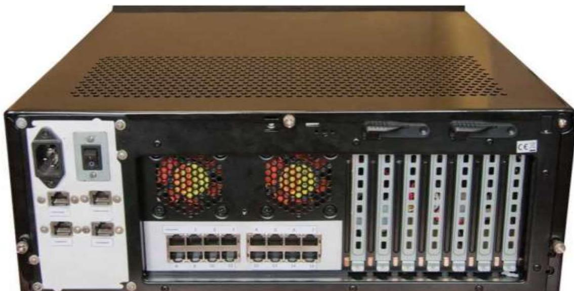
Прибор позволяет тестировать локальные и глобальные вычислительные сети (ЛВС, ГВС), проверять пропускную способность отдельных компонентов ЛВС или ГВС (маршрутизаторов, коммутаторов, ...).
